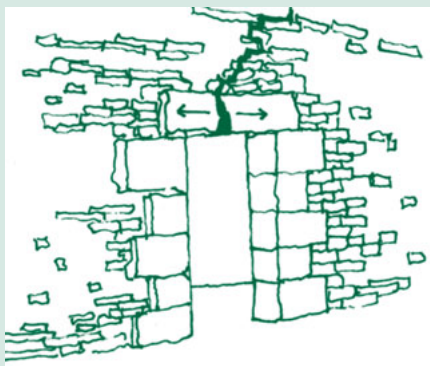
Rupture du linteau.
